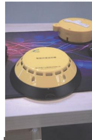
IoT CONNECT 2016 で展示されたスマートマンホール端末 (2018年10月12日高口康太撮影)
