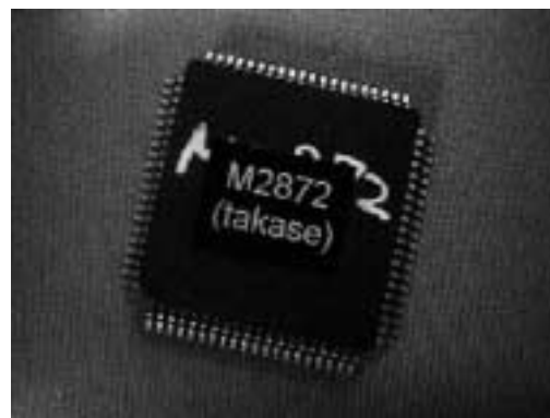
図A 著者が設計したチップ,リアルタイム色抽出処理回路(モトローラCMOS1.2 \mu mプロセス、チップサイズ2.3mmダイ)
