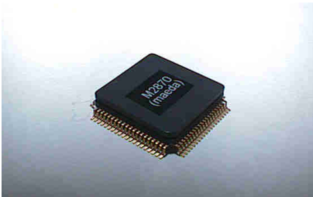
図 B.2: 物体検出チップの外形写真 (CMOS1.2 \mu m ルール, チップサイズ 2.3mm 角, QFP 80 ピン)
